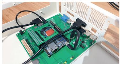
**19** Jetzt die am MiSTix Board befindliche USB-Erweiterung an der Rückseite befestigen, indem man den Kartenschaft abschraubt. Alternativ kann auch die Kartenschacht-Befestigung verwendet werden.
