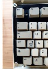
**5** Setze den Deckel auf, und verschraube das Tastaturgehäuse von der Unterseite mit den mitgelieferten Nylonschrauben.
