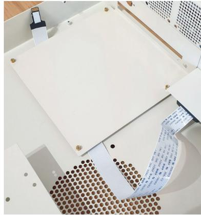
**7** Befestige das UnAmiga ITX Board mit 4 der M3 4 mm Schrauben, nachdem das SD-Karten Verlängerungskabel in den SD-Slot eingesteckt wurde. Jetzt können das LED- und das Power-Kabel an den entsprechenden Steckplätzen auf dem Motherboard eingesteckt werden. Beachte dass der Power-Schalter den Anschluss benutzt, der am nächsten zur Gehäuserückseite ist. Die anderen LED-Anschlüsse sind beschriftet.
