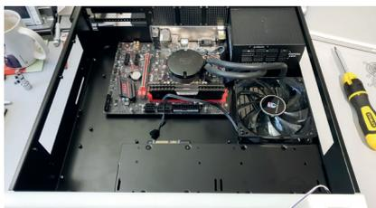
**9** SFX Netzteil eingebaut, achte auf die Leitungen für die Wasserkühlung und stelle sicher, dass sie sich biegen können, ohne eingeklemmt zu werden.
