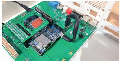
**18** Stecke den abgewinkelten HDMI-Stecker in die Seite des DE10 Nano Boards und verschraube das andere Ende mit der Rückseite des Montage-Rahmen.
