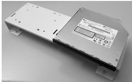
**4** Auf beiden Seiten des Rahmens gibt es vier Schlitzlöcher, durch welche die Schrauben für das Laufwerk passen. Beachte, dass die Schrauben für das DVD-Laufwerk nicht zum Lieferumfang gehören.
