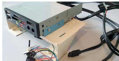
**4** Falls, zum Beispiel nach dem Einbau einer Wasserkühlung, kein Platz für einen normalen Laufwerkshalter vorhanden ist, kann auch dieses extra schlanke Modell verwendet werden.
