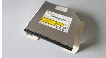
**4** Auf beiden Seiten des Rahmens gibt es vier Schlitzte, durch welche die Schrauben für das Laufwerk passen. Beachte, dass die Schrauben für das DVD-Laufwerk nicht zum Lieferumfang gehören.
