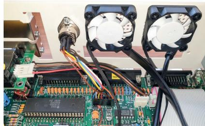
**7** Jetzt kannst du mit dem Verbindungskabel Tastaturegehäuse und Computer verbinden, und wir sind fertig.
