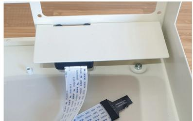
**6** Vorausgesetzt das AmiHybrid Setup wurde bei iMica Ltd gekauft, wirst du einen Montagerahmen und eine ATX-Adapterplatine, sowie den Pi4 Port-Adapter bekommen haben. Einfach komplett in die Mini-ITX Montage-Löcher schrauben, ohne Abstandhalter und das Power-LED Kabel des Gehäuses mit dem PWR-Anschluss auf ATX-Adapter verbinden. Bitte Online für Ergänzungen nachsehen, wie man am Pi4 die HDD-LEDs anschließt.
