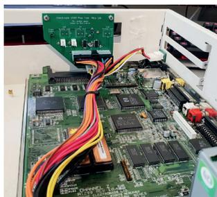
**5** Das ATX-Board hat außerdem noch einen Anschluss für die Power-LED, der mit dem LED-Board an der Vorderseite des Gehäuses verbunden werden kann. Damit sieht man zumindest, wenn die Maschine eingeschaltet ist. Zum Schluss bitte noch das Kabel vom Power-Schalter des Gehäuses mit dem entsprechenden Jumper auf der ATX Adapterplatine verbinden.
