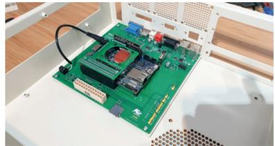
**17** Verbinde mit dem kurzen Micro-USB auf USB Kabel wie abgebildet das DE 10 Nano-Board mit dem MiSTiX-Board.
