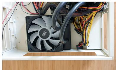
**9** Jetzt wird das Netzteil an seinem Platz verschraubt. Der Lüfter kann da drüber oder da drunter montiert werden. Ich bevorzuge drüber, damit er die warme Luft besser auffängt und abführt, aber ich bin sicher, jemand anders wird völlig anderer Meinung sein. Wenn man es anders macht, wird jedenfalls ein Drittel des Lüfters durch das Netzteil abgedeckt.
