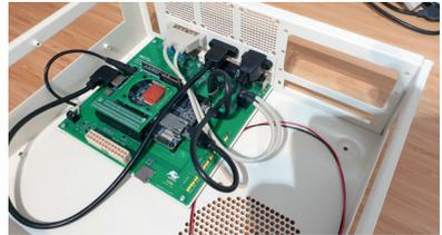
**21** Jetzt wird der Power-Schalter angeschlossen an „PWR“ und die Festplatten LED an die mit „HDD“ markierte Stelle (s. Bild weiter oben).
