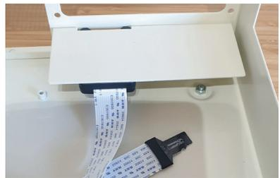
**6** Nachdem wir das SD-Verlängerungskabel unter dem ITX-Montagerahmen verlegt haben, verschrauben wir die 4 HEX-Abstandhalter mit dem Schlüssel oder Schraubendreher. Dadurch wird das SD-Karten Verlängerungskabel nächstmöglich an die Rückseite des ITX-Boardes gebracht.
