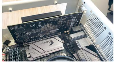
**14** Es ist ein bisschen eng, aber mit einem dünnen Schraubendreher kann man von oben die Schrauben anziehen. Es gibt eine kleine blanke Abdeckplatte um die Oberseite ein wenig aufzuräumen.
