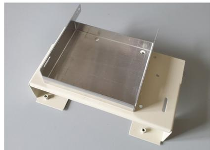
**3** Das DVD-Laufwerk passt genau in den Montagerahmen. Kontrolliere, ob es wirklich gut sitzt und durch die Öffnung im Vorderpaneel passt.
