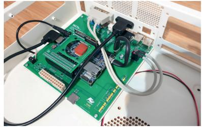
**20** Jetzt den RJ45 am Rückpaneel anschrauben und mit dem DE10 Nano verbinden. Beachte dass das LED-Kabel an beiden Seiten vorbei passt.
