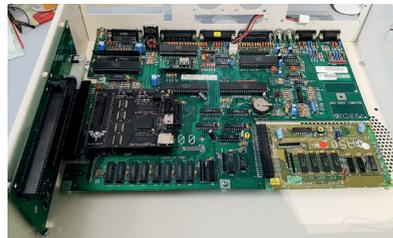
**ABOVE:** Bild des Zorro-Board und A500 Board im Gehäuse mit Verschraubung
