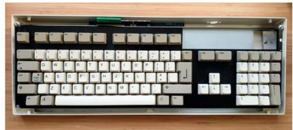
**4** An der Unterseite hält es bereits, oben muss die Tastatur an beiden Seiten mit M3 Schrauben und Unterlegscheiben fixiert werden.
